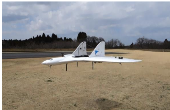
エアロセンス製の自律型無人航空機システム：滑走路及び操縦者は不要
