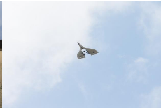
エアロセンス製の自律型無人航空機システム：滑走路及び操縦者は不要
