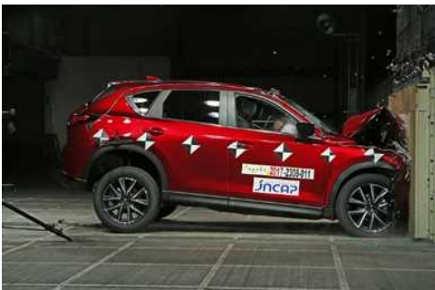
（前面衝突試験の様子）
