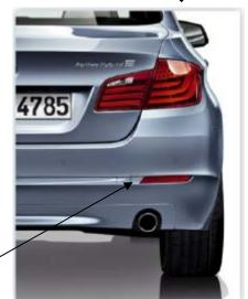
後部反射器において、当該反射器の製造が不適切なため、反射器の表面部(レンズ部)が正しく成型 されていないものがある。そのため、反射照度が不足し、保安基準第 38 条の基準に適合しないおそ れがある。
