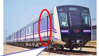
ドアの外吊り化によりドア部分の構体構造を見直し(設計やり直し)
