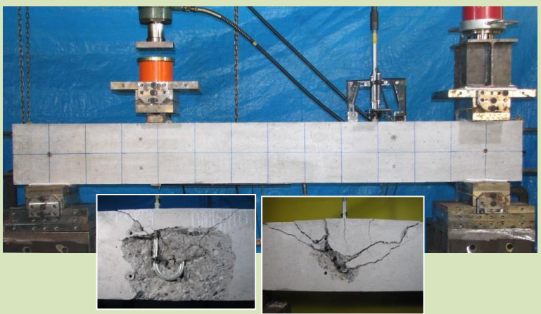
[構造実験手法と試験体破壊状況の一例]
