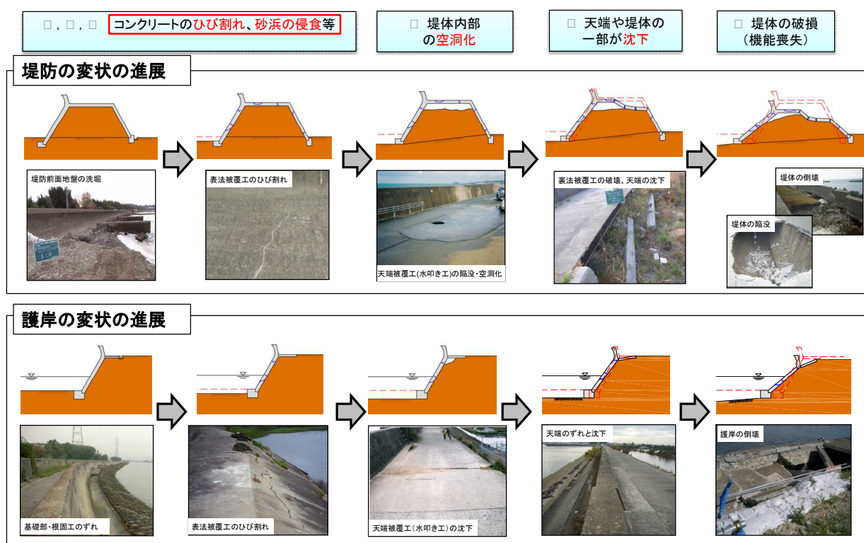
図-2.6 変状の進展の具体例
