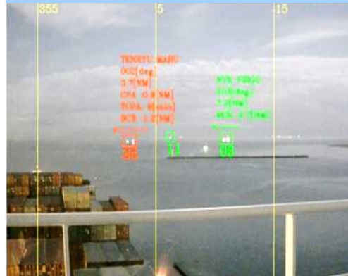
濃霧中における高感度カメラ画像による検出
