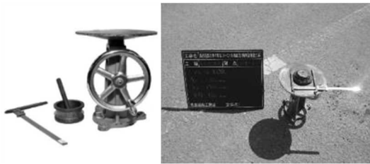
図-10 テーブルフロー値の測定器具と測定写真
