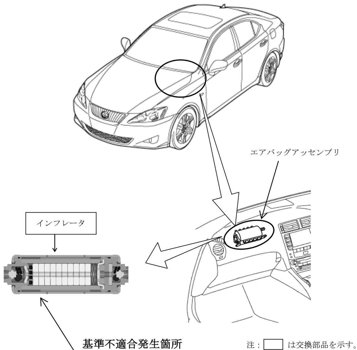
助手席用二段展開制御式エアバッグのインフレーター（膨張装置）において、ガス発生剤の吸湿防止が不適切なため、温度および湿度変化の繰り返しによりガス発生剤が劣化することがある。このため、エアバッグ展開時にインフレーター容器が破損するおそれがある。
