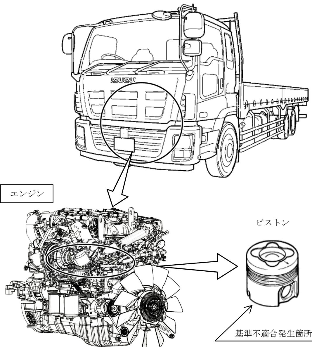
大型トラック用エンジンにおいて、ピストン燃焼室壁部に燃焼による熱と圧力が繰り返し作用し、そのダメージが蓄積して亀裂に至るものがある。そのため、そのままの状態で使用を続けると、ピストン燃焼室壁部の亀裂が進行して穴が開き、最悪の場合、エンジンの出力低下及び白煙排出により、走行不能に至るおそれがある。
