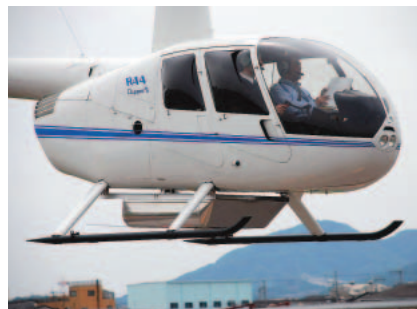
レーザー計測装置 ヘリコプター下部に搭載
