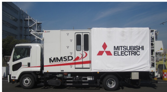
三菱インフラモニタリングシステムⅡ (MMSD®Ⅱ) 計測車両
