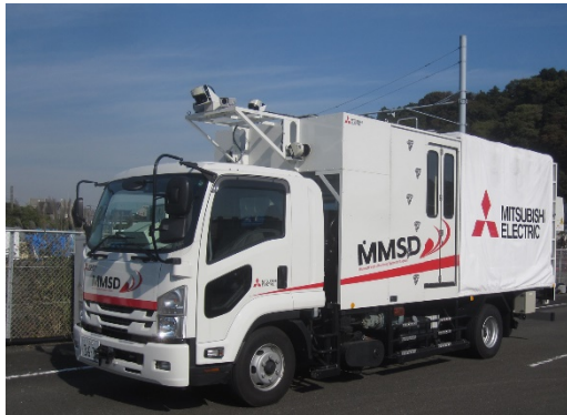
三菱インフラモニタリングシステムⅡ (MMSD®Ⅱ) 計測車両
