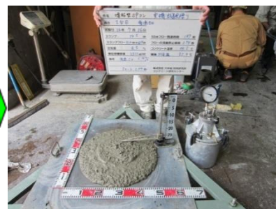
高流動コンクリート (スランプフロー55cm)
