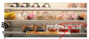
RFIDリーダーから電波を発信し、電子タグから返ってくる電波を読み取る。
