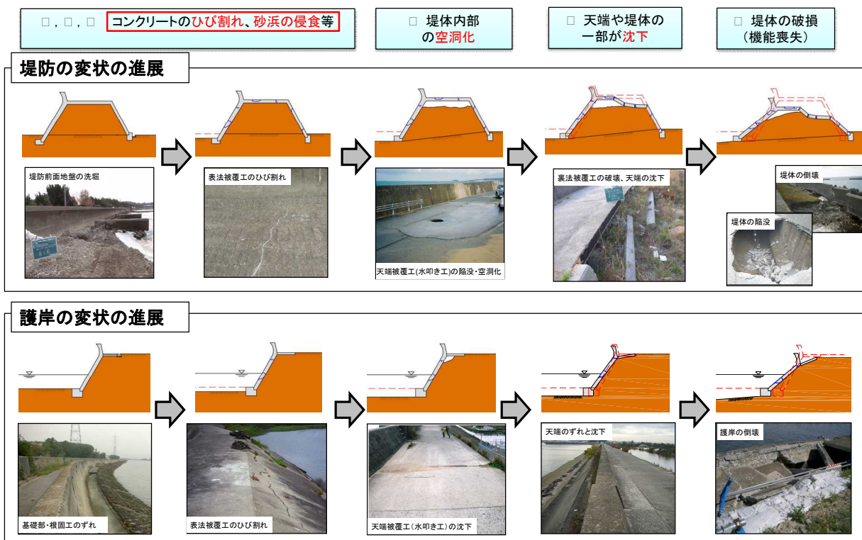
図-2.65 変状の進展の具体例
