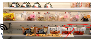
RFIDリーダーから電波を発信し、電子タグから返ってくる電波を読み取る。 シール型の電子タグが貼られたおにぎり。これら2つは同じ高周波のRFIDタグでは識別できないが、RFIDであれば識別が可能。
