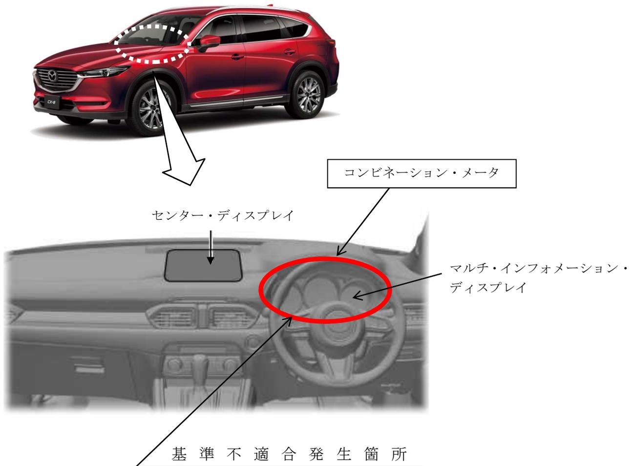
コンビネーション・メータにおいて、通信用プログラムが不適切なため、通信信号が送受信できなくなり、マルチ・インフォメーション・ディスプレイにアドバンスト・スマート・シティ・ブレーキ・サポート等のシステム異常が表示され、当該装置が機能しないことがある。また、カメラの画像表示に切り替える操作をした場合でも、センター・ディスプレイにカメラの画像が表示されないため、車両の直前および直左等、周囲の状況が確認できず保安基準に適合しないおそれがある。
