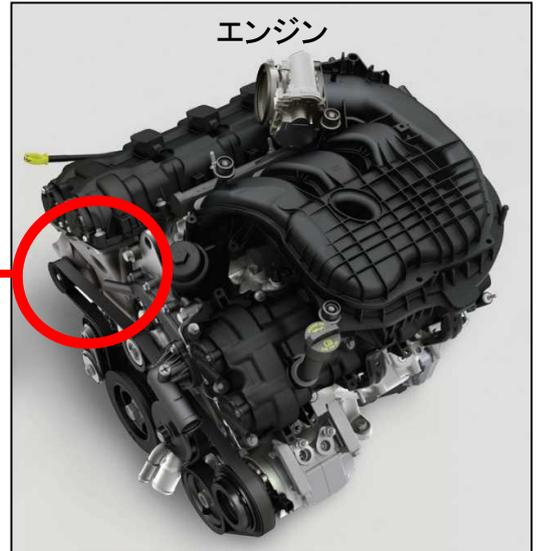
電気装置において、オルタネータの設計が不適切なため、整流器の電気容量が不足しているものがある。そのため、整流器が発熱し、そのままの状態で使用を続けると、整流器が損傷してバッテリーに電源が供給できず、警告灯が点灯し、最悪の場合、走行中にエンジンが停止し、再始動できなくなるおそれがある。
