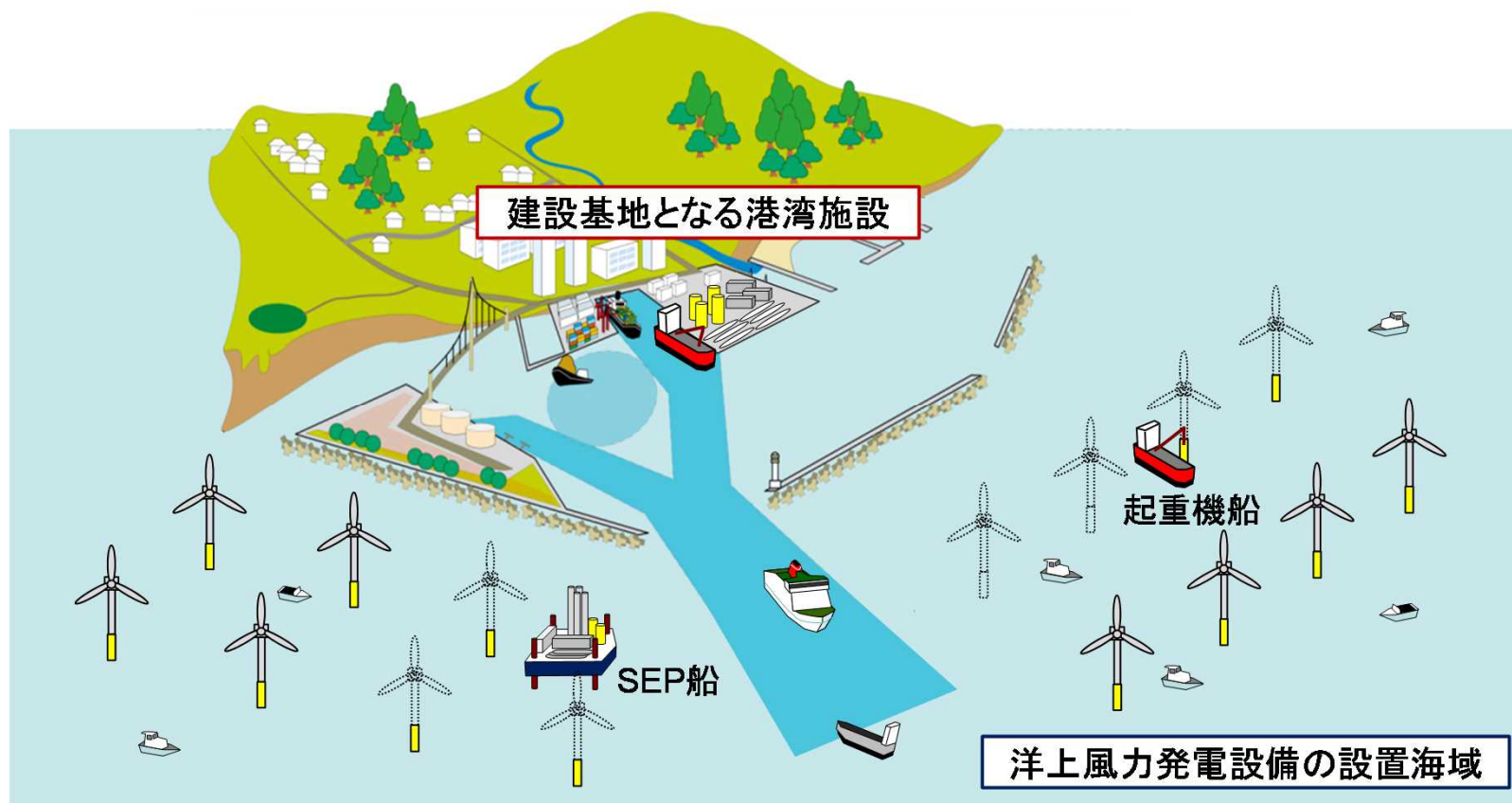
洋上風力発電設備の施工のイメージ
