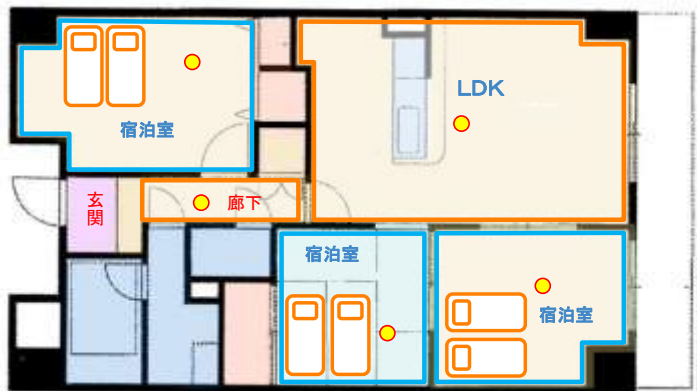
● 非常用の照明装置
