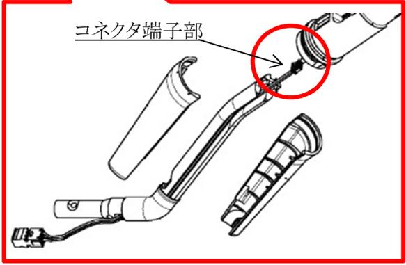
大型トラックの灯火装置において、前照灯操作スイッチの配線用端子のかしめが不適切なため、当該端子部の接触抵抗が増大するものがある。そのため、当該端子部が導通不良を起こし、前照灯が不灯となるおそれがある。
