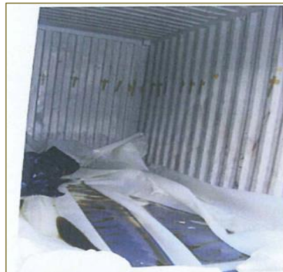
フレキシタンクの損傷状態
