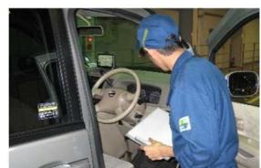
自動車整備工場では、車検や法定点検時等のための車両入庫時には、故障の有無の確認や、故障箇所の特定のため、スキャンツールによる故障診断が行われている<sup>4</sup>。また、スキャンツールによる故障診断の結果、DTCが検出された場合には、必要な整備・修理を行い、DTCを消去した上で保安基準適合性の検査を行ってユーザーへ車両を返却する。
