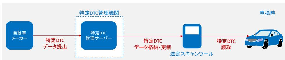
図 3.2.1 特定 DTC 情報の流れ（イメージ）
