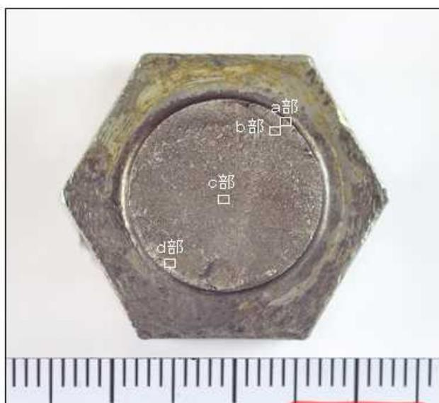
写真8 六角ボルト頭部の破断面
