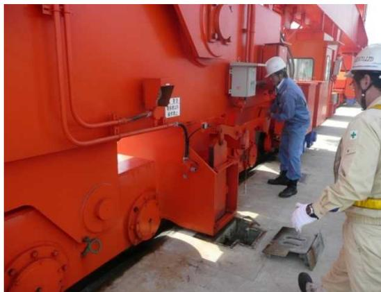
写真 2.2.3 転倒防止アンカー設置事例
