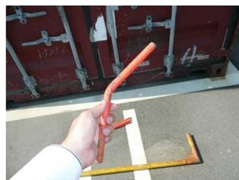
写真 2.2.5 コンテナ転倒防止対策
