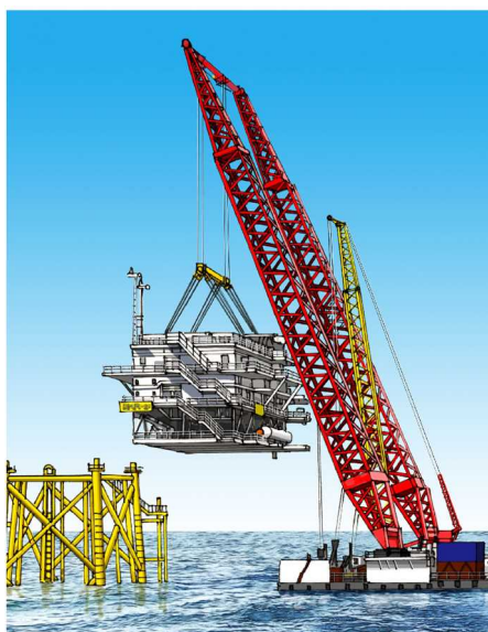
図 3-7 サブステーションの施工イメージ
