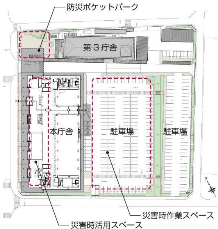
図—日光市庁舎 配置図（災害時対応）
