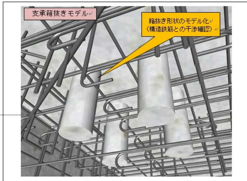
図 30 モデルイメージ（支承箱抜き：下部工）
