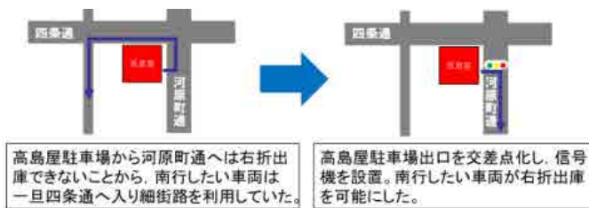
図 5 高島屋京都店駐車場出口前交差点改良前後の状況
