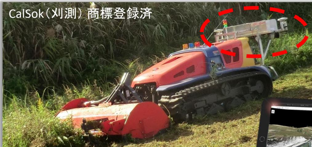
収録ユニット、GNSS/IMU      パトライト      GPSアンテナ
