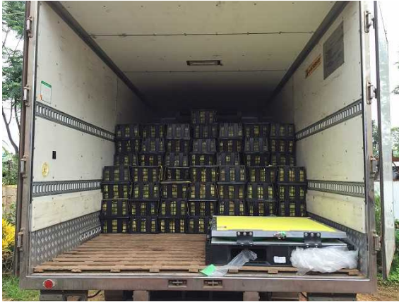
【トラック荷台後部に防振パレットを設置】
