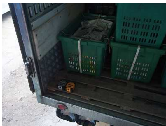
【トラック荷台後部に衝撃度・温湿度計測器を設置】
