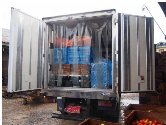
【手前側に防振パレットを設置】
