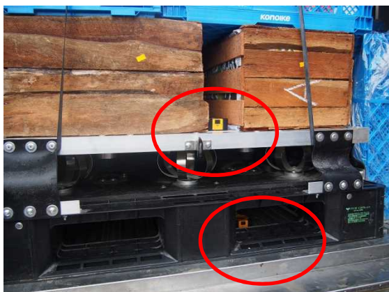
【衝撃度・温湿度計測器を防振パレットの上、荷台の上の2カ所にセッティング】
