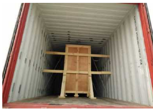
【選果機のバンニング（タイ）】 【選果機のコンテナ内ラッシング（タイ）】
