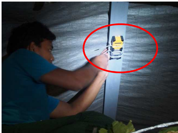
【トラック荷台後部に衝撃度・温湿度計測器を装着】
