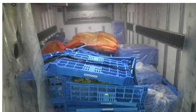
【設定温度 5℃で輸送。ヤンゴン到着時、紐で縛るなどの対策を行っていたが、荷が崩れていた】
