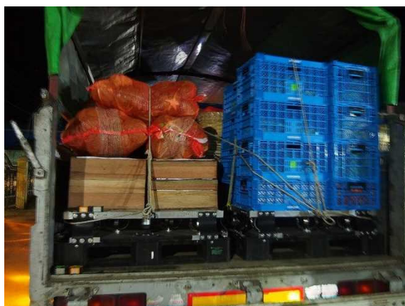
【大型トラック最後尾に防振パレットを2台設置。比較の為、オリコンと現状梱包状態、2種類にて積載】
