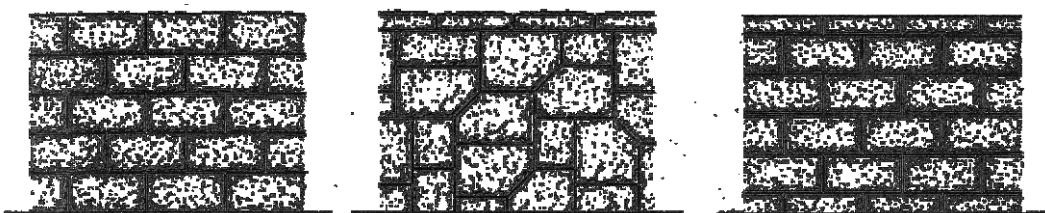
12. 切石積は、切角石を用いた石積で、大きさの異なる大小の切石材を組合せ、面をそろえて積み上げたもののこととする。
