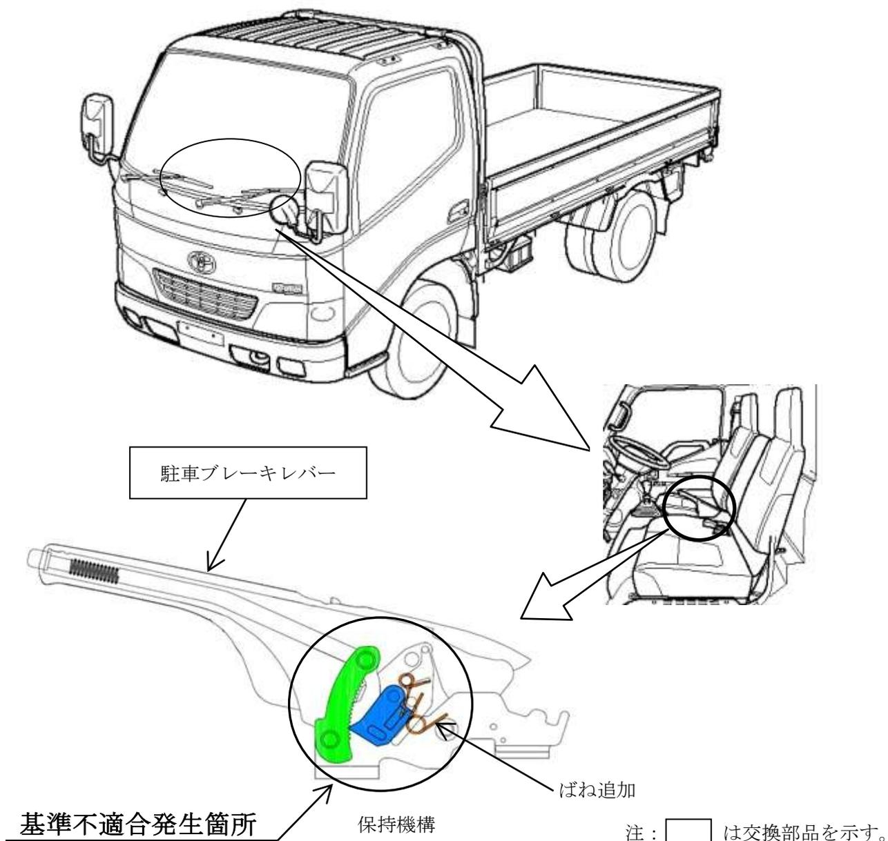
手動式駐車ブレーキレバーにおいて、保持機構のばね力が不適切なため、レバーを引き上げた際に保持用ギヤの歯先同士がすり合った状態で保持されると、振動等が加わった場合につり合いが外れ、当該レバーが解除されることがある。そのため、駐車制動力が低下し、最悪の場合、駐車状態の車両が動き出すおそれがある。
