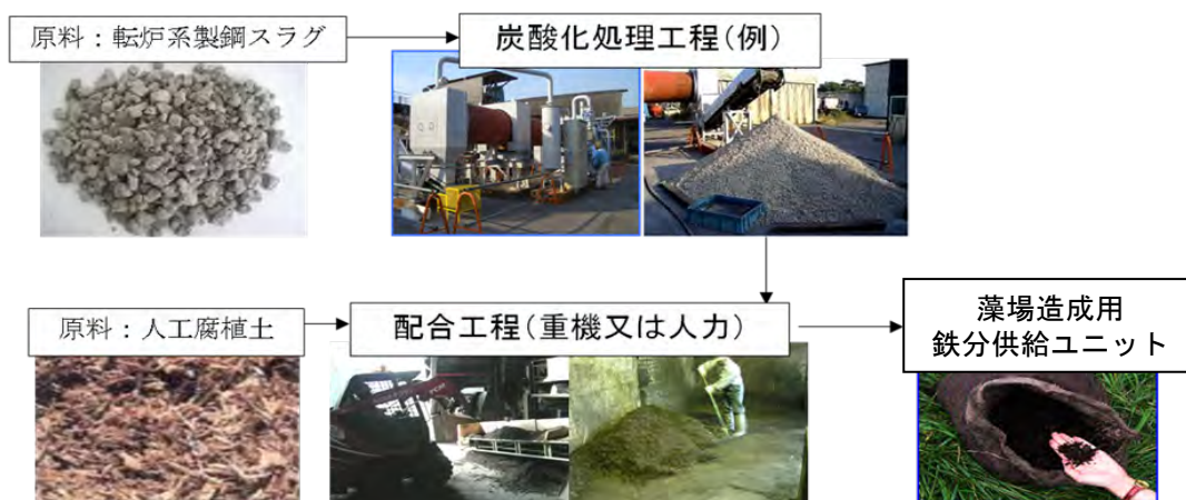
図 3.10.3 藻場造成用鉄分供給ユニットの製造工程
