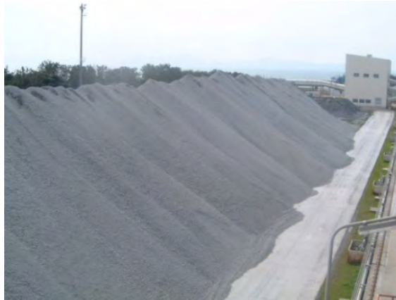
図 3.13.5 石炭灰造粒物仮置場
