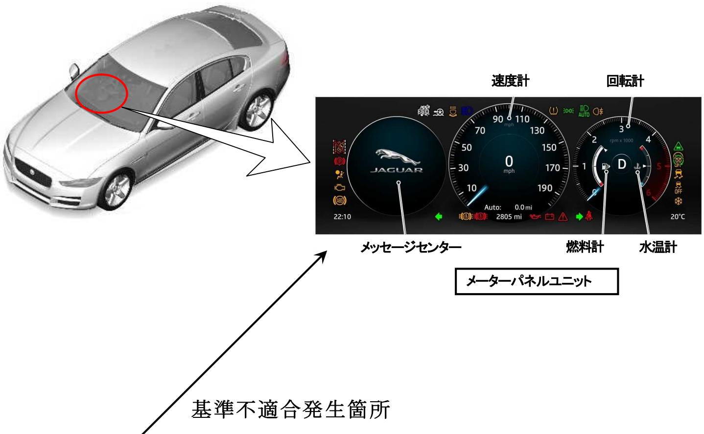
メーターパネルユニットの制御プログラムが不適切なため、当該ユニットの内部温度を誤って異常検知し、強制的に再起動することがある。そのため、走行中にメーターパネルが消灯し、速度計または警告灯等が表示されないおそれがある。
