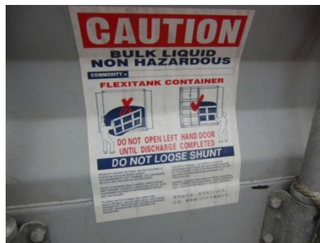
図 7.52 フレキシタンクの警告ラベル
