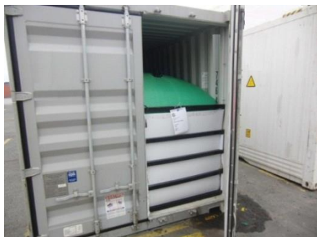
図 7.51 フレキシタンクを取り付けたコンテナ
