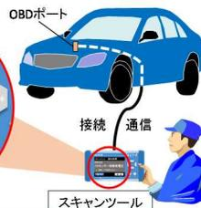
法定スキャンツールを接続して「特定DTC」が検出された場合、検査不合格
