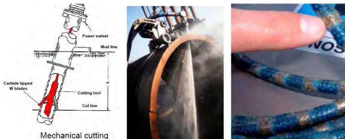
図 4.4.6-9 海底機器の切断（陸上も含む）（出典：JOGMEC）
