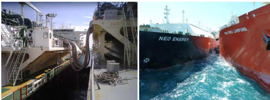
図 4.3.3-14 FSRU での LNG の出荷 (Side-by-Side)
