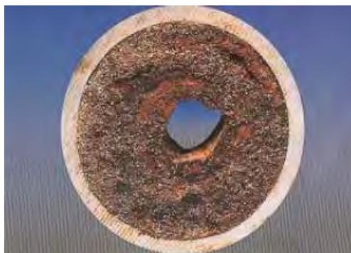
図 4.4.6-3 ライザー内部で変質した流体 (出典: 海洋工学ハンドブック 2010)
