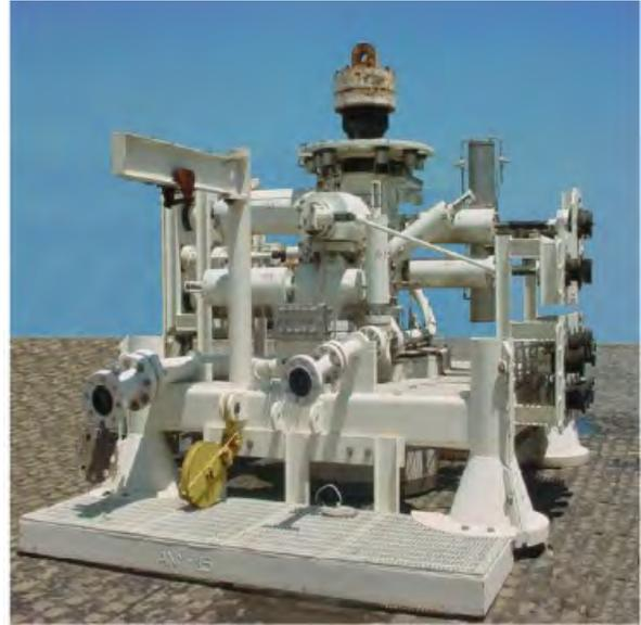
図 4.4.2-1 クリスマスツリー (wet) の概念と構成 (出典 : 海洋工学ハンドブック 2010)
