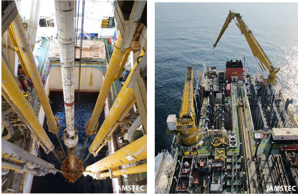
図 5.3.1-9 「ちきゅう」のライザーテンショナーとデリッククレーン (出典：JAMSTEC)
