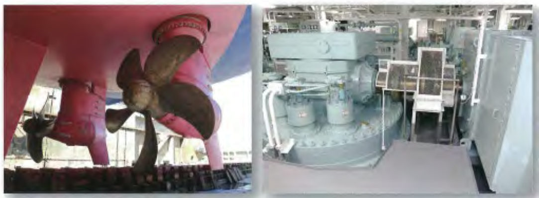
図 5.2.2-2 アジマス推進器、推進電動機 (出典：JAMSTEC)
