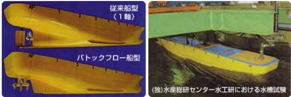
図 5.3.1-3 バトックフロー船型 (バトックフロー船型は船型と水流の干渉が少なく推進抵抗を抑えることができるとされる理想船型の一つ。ポッド推進器との組合せが多い)
