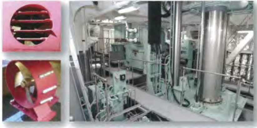
図 5.2.2-3 トンネル式／昇降旋回式バウスラスタ、バウスラスタ室
