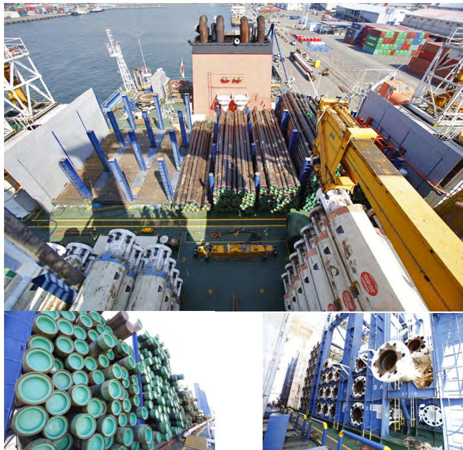
図 5.3.1-7 「ちきゅう」でのケーシングパイプとライザーパイプの保管
