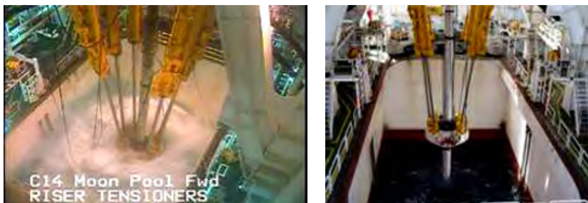
図 5.3.1-5 「ちきゅう」のムーンプール（開口部（幅 12m×長さ 22m））
