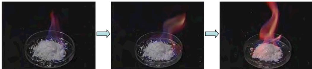
(4) MHから分解するメタンの燃焼反応が継続し、徐々にMH粉末は消失していく
