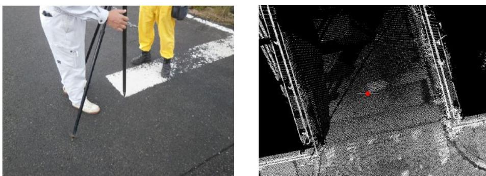
写真 3-19 検証用基準点と同箇所の点群データ
