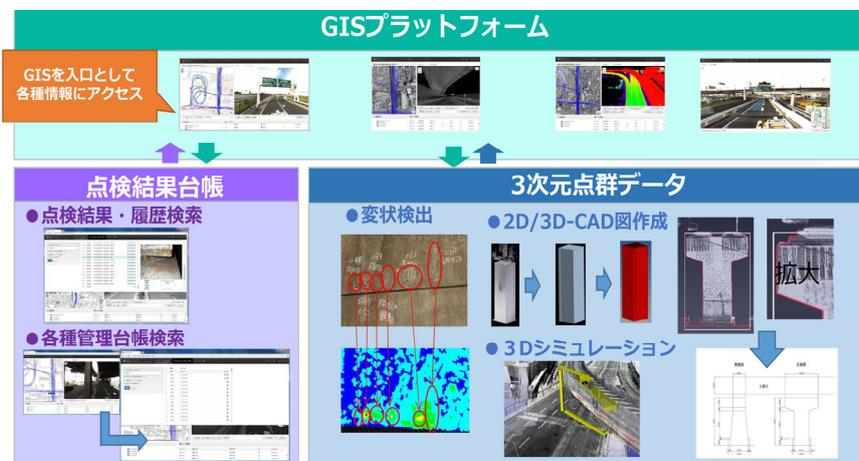
図 3-1 調査に利用するシステムの概念図
