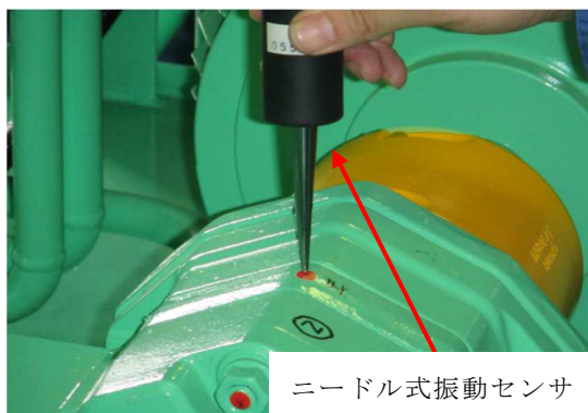
写真 4.2 振動測定状況（ニードル式振動センサ）
