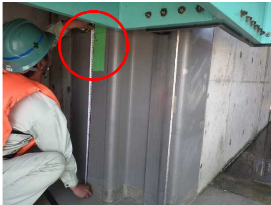
写真 5.2 扉体のずり落ち量測定状況
