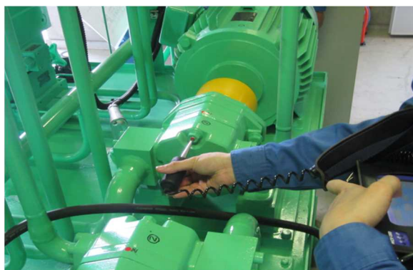
写真 4.2 振動測定状況（ニードル式振動センサ）
