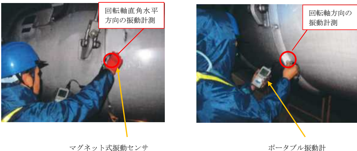
写真 4.1 振動測定状況（マグネット式振動センサ）
