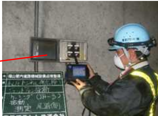
写真 4.3 振動測定状況
