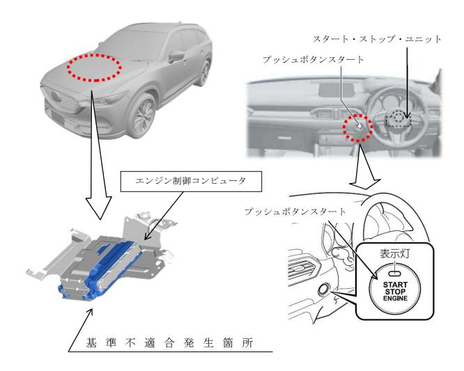
ディーゼルエンジンにおいて、エンジン制御プログラムが不適切なため、エンジンを停止させた際の僅かなエンジン回転を異常と判定し、エンジン制御コンピュータへの電源供給が停止しなくなる。そのため、スタート・ストップ・ユニットがスタータ回路の短絡と判定し、プッシュボタンスタートを押しても、電源ポジションがONに切り替わらず、エンジンが始動できなくなるおそれがある。
