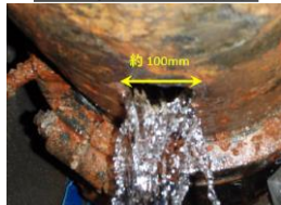
路面聴音による漏水調査(徳島市)
