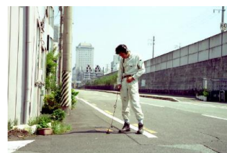
路面聴音による漏水調査(徳島市)
