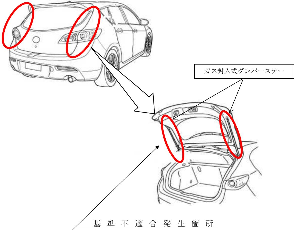
リヤゲートのガス封入式ダンパーステアにおいて、外筒のエンドキャップ部の塗装が不適切なため、塩害地域の塩分の影響で腐食することがある。そのため、そのままの状態で使用を続けると、腐食が進行し、外筒が膨らみ、エンドキャップが割れ、リヤゲートを開く際に外筒が破裂し、最悪の場合、周囲の人が負傷するおそれがある。
