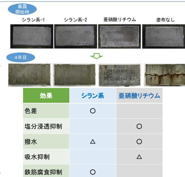
表面含浸材の鉄筋腐食抑制効果の検証
