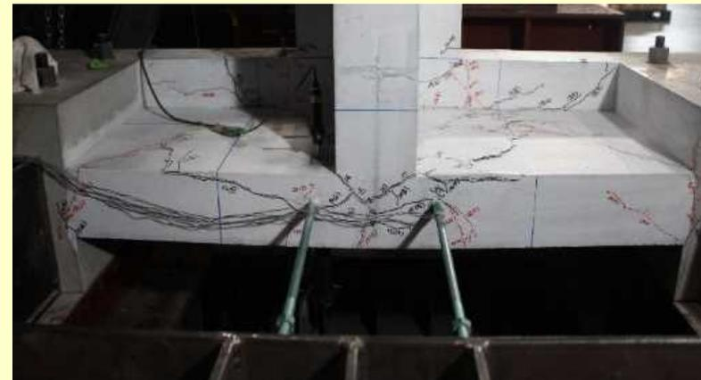
図6 アンカー部の破壊状況
