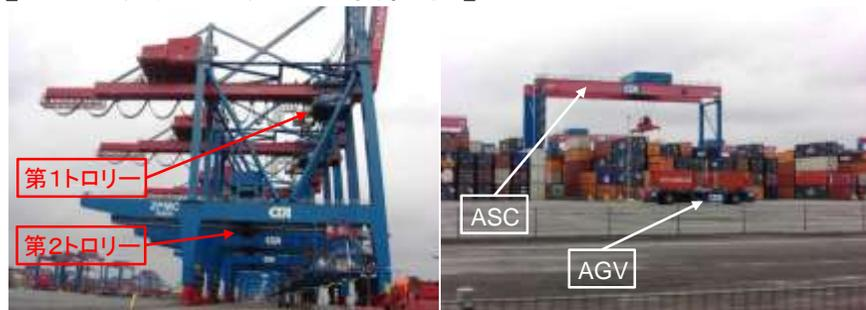
ダブルトロリー方式ガントリークレーン ※第2トロリーは、完全自動化
